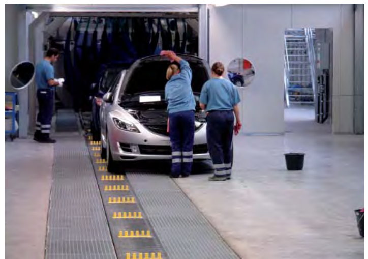
Mattop 3125 con empujadores T2 DIN
