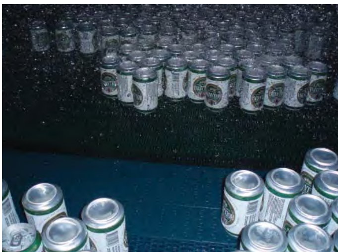
Calentador de botellas de cristal con malla raised rib 2000 y transferencia DTS®-C
