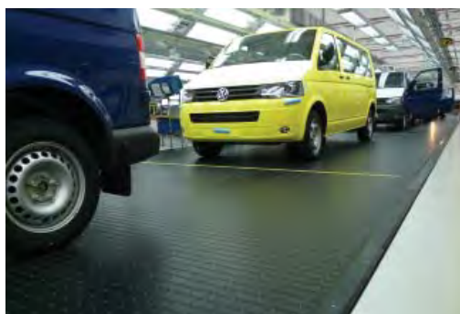
Banda modular 6995 en limpieza de interior de automóviles
