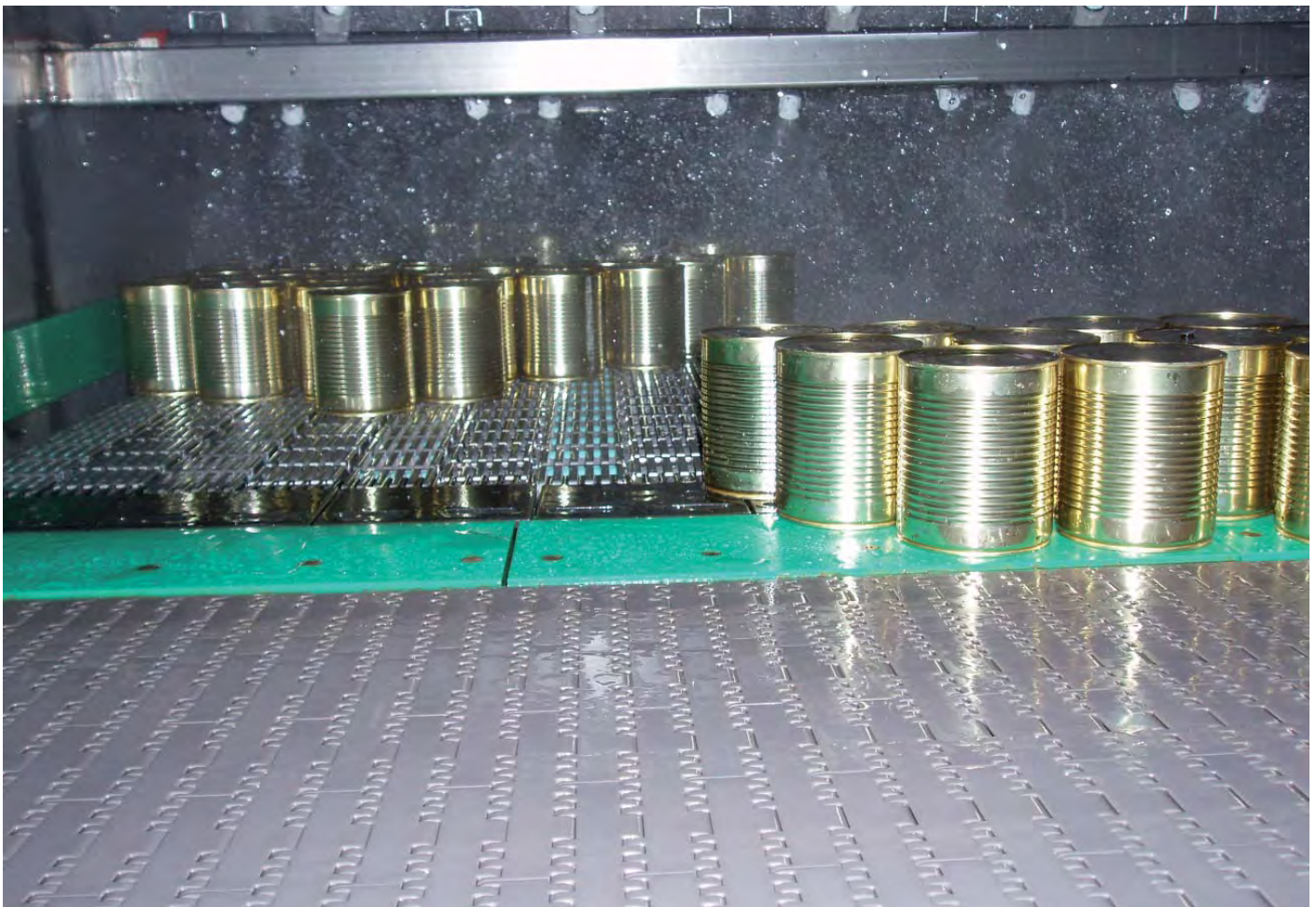
Cinta fortrex 9227 en un túnel de pasteurización de alimentos
