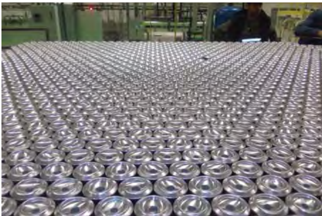
Descarga de lavadora de latas con la malla 5936
