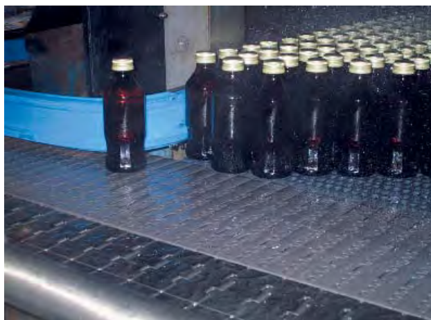
Transferencia de botellas con la malla 7705
