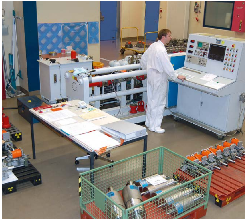
Prueba en la planta de amortiguadores hidráulicos de diferentes marcas utilizando un banco de pruebas móvil de LISEGA
