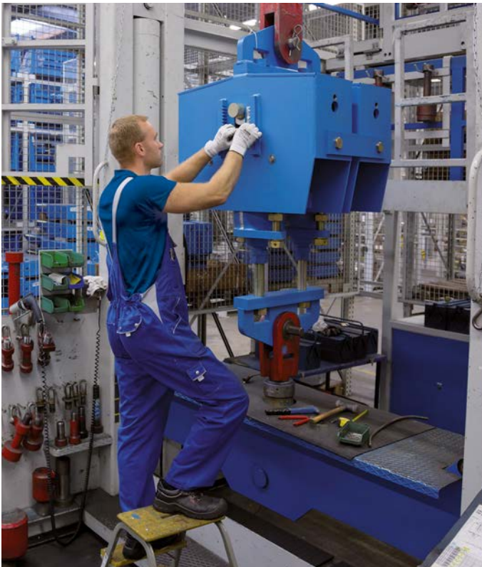
Calibración, pruebas y bloqueo de un soporte colgante de carga constante tipo 12 en un banco de pruebas de 500 kN
