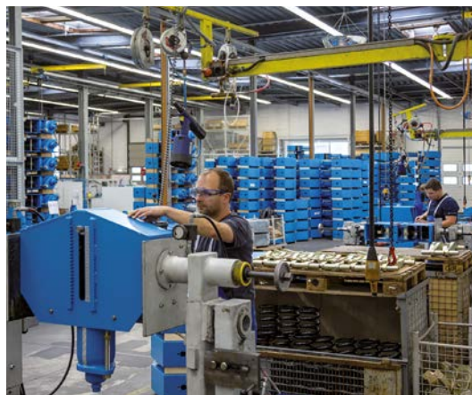
Montaje final de un soporte colgante de carga constante
